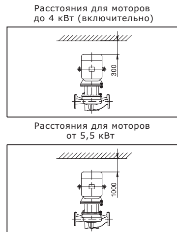
Рис. 8 Расстояния до стен/потолка для насосов TRV
