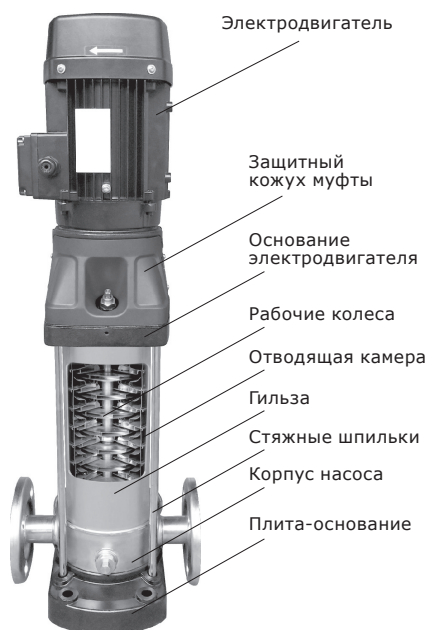
Рис. 3 Насос серии CRV-CN
