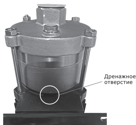
Рис. 11 Дренажное отверстие торцевого уплотнения
