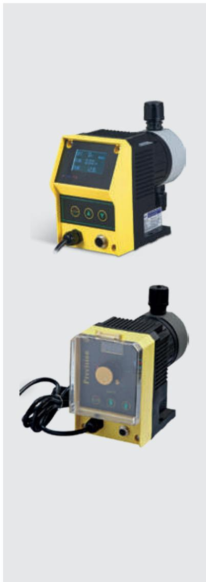
Соленоидные насосы мембранных типа также известны как электромагнитные дозирующие насосы. Сердцем соленоидного насоса является катушка индуктивности. Внутри нее движется шток или плунжер, соединенный с мембраной. Во время движения плунжера мембрана соответственно изгибаются – изменяется объем рабочей камеры
